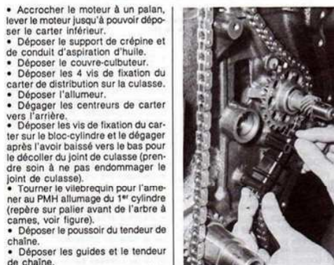
Montage d'une glissière de chaîne
