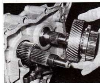
Dépose de l'ensemble moyeu de synchroniseur, bague de synchroniseur et pignon de renvoi de 5 e
