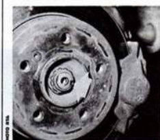
Montage de l'arbre de roue sur le moyeu Flèche après serrage au couple, mater l'écrou
