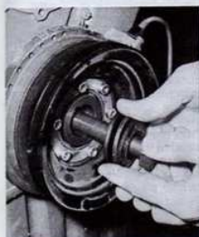
Mise en place de la poulie de vilebrequin : orienter les trois rondelles Belleville dans le même sens, concavité vers la poulie
