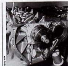
Montage d'un joint de palier arrière
