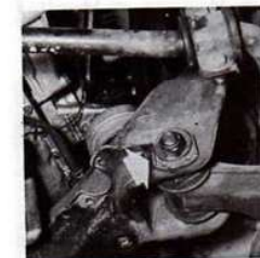
Excentrique de réglage de train avant
