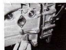
Dépose de la vis de maintien de l'axe de pignon de M. AR
