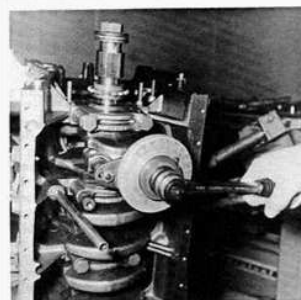
Serrage des chapeaux de bielle à l'aide du contrôleur d'angle de serrage
