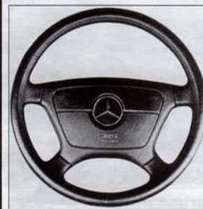
Chez Mercedes Benz, l'airbag (coussin de protection gonflable) s'appelle également SRS.
