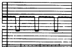
Coupure d'une diode excitatrice
