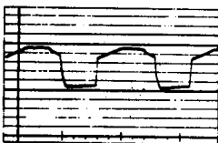
Court-circuit d'une diode excitatrice
