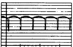
Défaut de phase (bobinage de stator en court-circuit ou interrompu)
