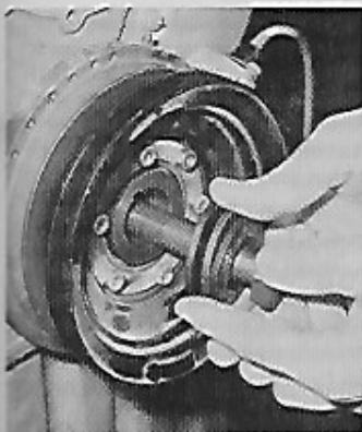
Mise en place de la poulie de vilebrequin : orienter les trois rondelles Belleville dans le même sens, concavité vers la poulie
