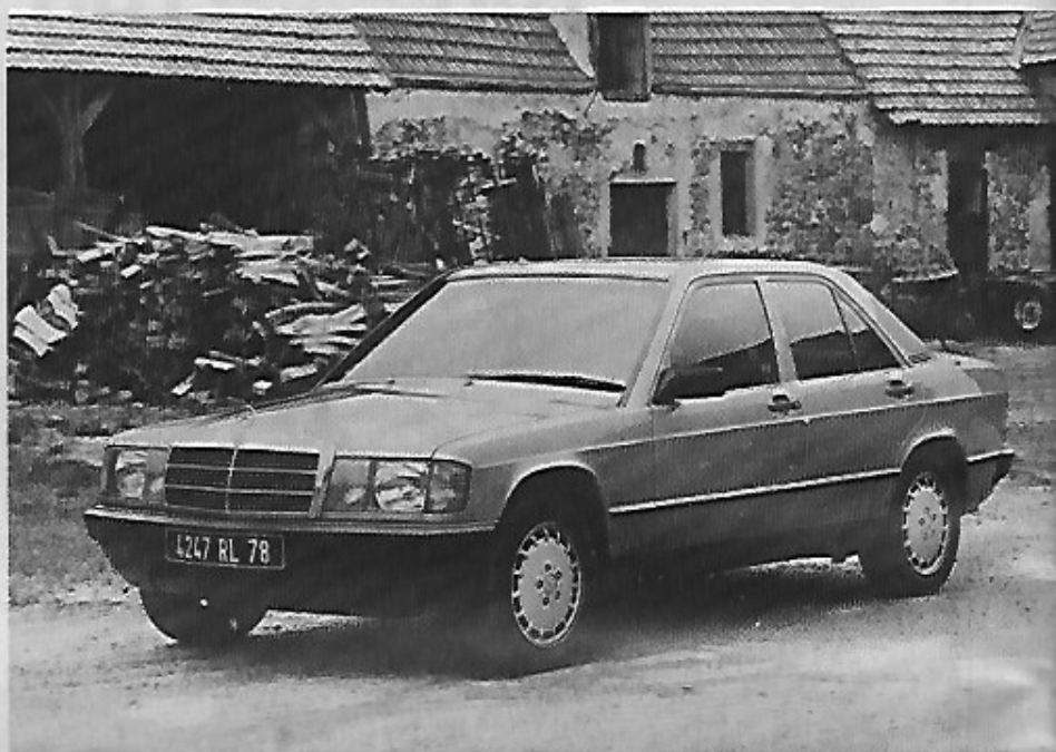
Le dessin de la Mercedes-Benz « 190 » fait la synthèse d'une carrosserie compacte, d'une silhouette moderne (Cx 0,32) en gardant un air de famille avec les précédents modèles de la marque (Photo RTA).
