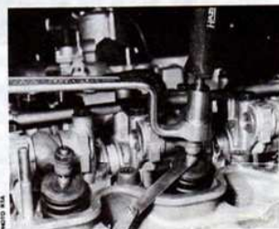
Réglage du jeu aux soupapes
