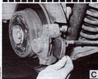
Dépose des plaquettes arrière A. Débranchement des axes de maintien - B. Dépose du ressort de pression - C. Dépose d'une plaquette
