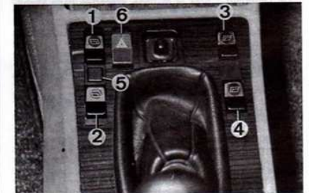
Commande des lève-glaces électriques. 1. AV gauche - 2. AR gauche - 3. AV droit - 4. AR droit - 5. Interrupteur de sécurité des glaces AR - 6. Interrupteur du signal de détresse. (Photo RTA).
