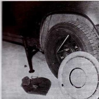
Mise en place du cric. (Photo RTA).
