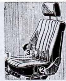
Réglage des sièges avant. 1. Longitudinal - 2. En hauteur - 3. Inclinaison du dossier.
