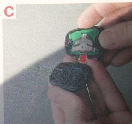
Remplacement de la pile de la télécommande.
