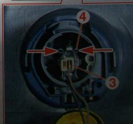
Remplacement de la lampe du projecteur antibrouillard gauche.
