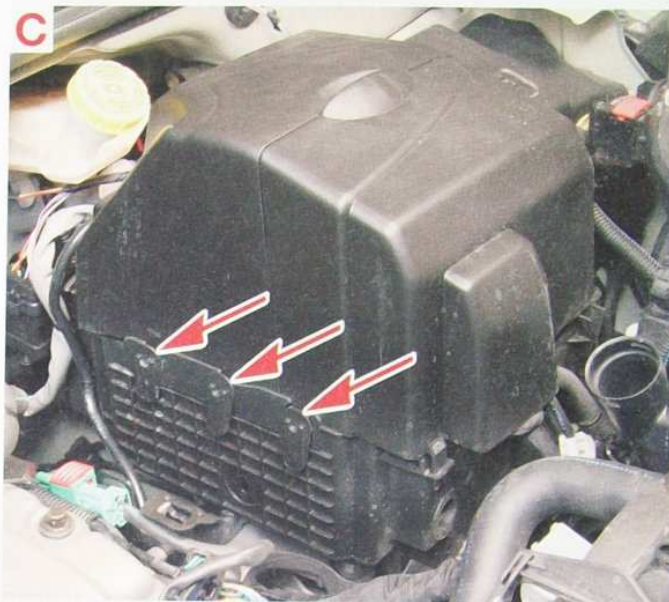
Vue boîtier de filtre à air déposé sur versions 1.1i et 1.4i.
