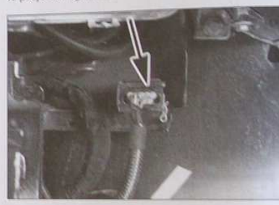
IMPLANTATION DU BOÎTIER RELAIS D'INTERDICTION DE DÉMARRAGE (boîte de vitesses Sensodrive)
