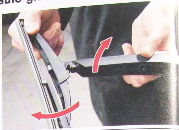
Dépose du balai d'essuie-glace arrière.
