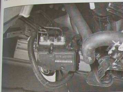
IMPLANTATION DU GROUPE HYDRAULIQUE
