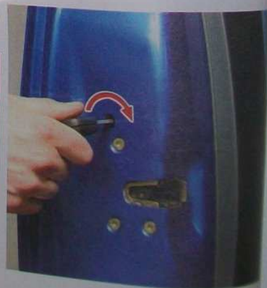
Verrouillage de secours de la porte conducteur.
