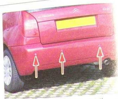
Implantation des capteurs d'aide au stationnement
