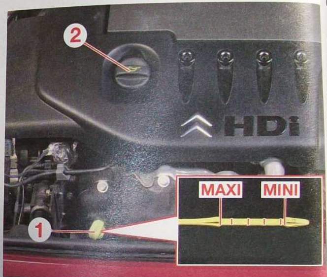
▲ Contrôle du niveau d'huile moteur sur la jauge (moteur 1.4 HDi). L'huile ne doit jamais dépasser le repère « maxi » ou descendre en dessous du repère « mini ».
