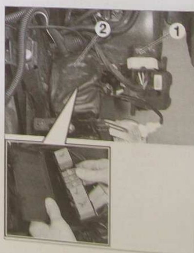
IMPLANTATION DES RELAIS DE CHAUFFAGE ADDITIONNEL ET DU BOÎTIER DE PRÉCHAUFFAGE 1. Boîtier de préchauffage 2. Relais de chauffage additionnel
