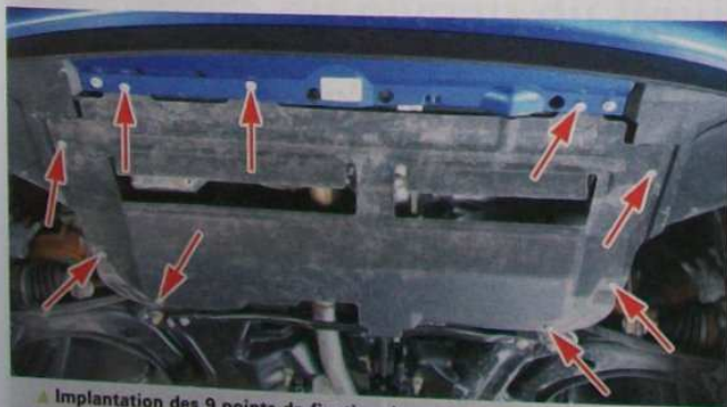
▲ Implantation des 9 points de fixation du carénage sous moteur 1.4 HDi.
