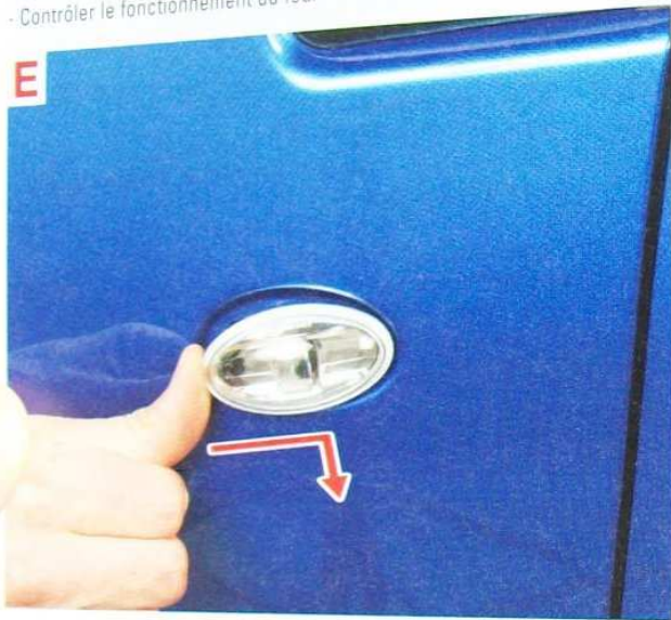
1. Dépose du clignotant latéral gauche.
